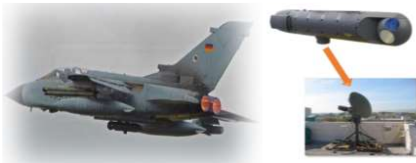
ภาพที่ ๑๐ เครื่องบินแบบ TORNADO (ภาพซ้าย) และอุปกรณ์ตรวจจับ RECCE LITE (ภาพขวา) ที่มา : Führungsakademie der Bundeswehr (2021 : p.49)
